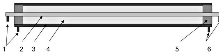
Рис. 2. Схема испытательного стенда: 1 — контакты для подключения генератора сигналов; 2 — проволока; 3 — труба; 4 — среда, заполняющая трубу; 5 — диэлектрическая пробка; 6 — контакты подключения источника питания
