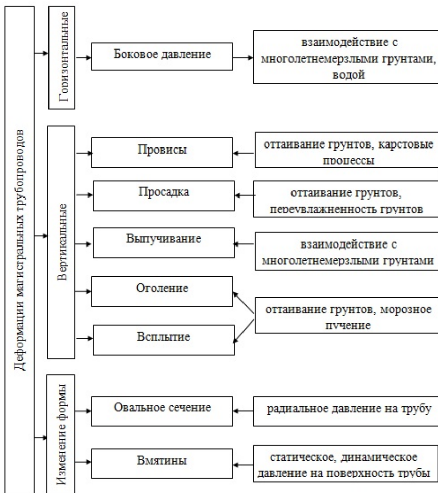
Рис. 4. Классификация деформаций магистральных трубопроводов
