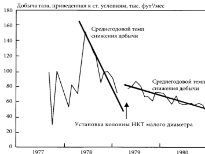
Рис. 2. Пример изменения дебита скважины после установки ГНКТ [1]
