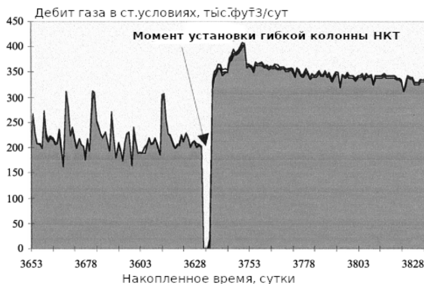
Рис. 1. Пример изменения добычи после установки ГНКТ [1]
