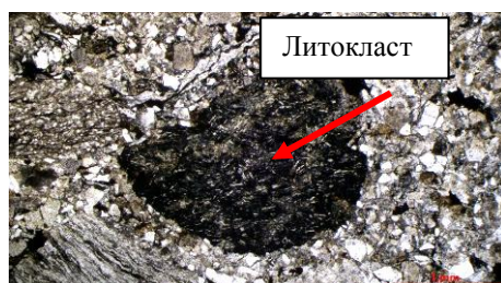
а) Пирокластический материал — в центре шлифа отмечается литокласт андезита. Увеличение 2,5×10
