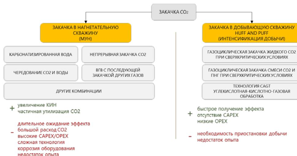
Рис. 2. Типовые методы воздействия  $\text{CO}_2$  на пласт
