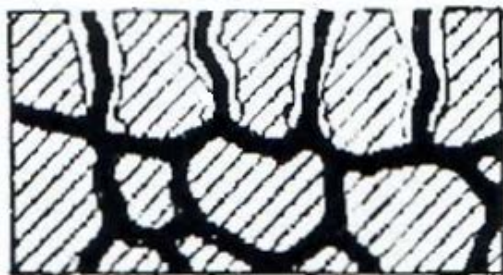
Рис. 1. Уширение межзеренной границы при диффузионном выносе углерода
