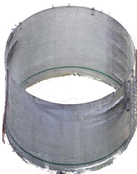
Рис. 2. Вид облака точек внешней поверхности стенки РВС
