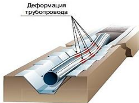
Рис. 2. Деформация нефтепровода при потере устойчивого положения
