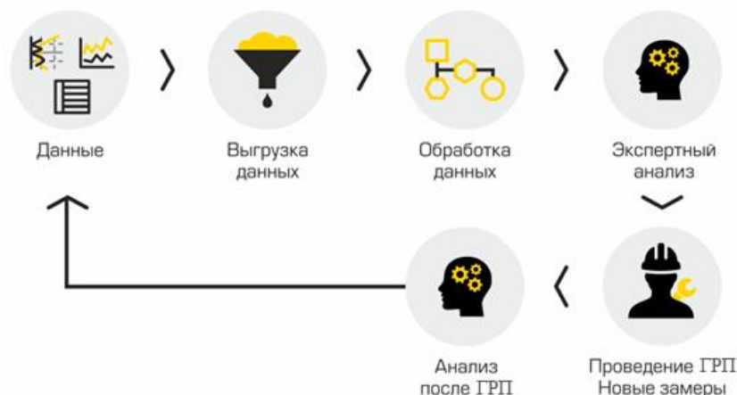
Рис. 1. Структурная схема классического способа подбора скважин-кандидатов Fig. 1. Structural diagram of the classical method for selecting candidate wells
