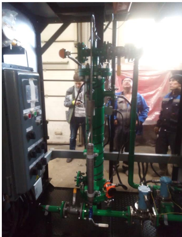
Рис. 3. Установка нового поколения для измерения 3-х фазной продукции на заводской площадке изготовления
