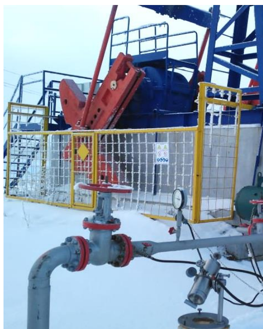
Рис. 4. Фотография прибора для измерения вязкости продукции на скважине Fig. 4. Photograph of a device for measuring product viscosity at a well
