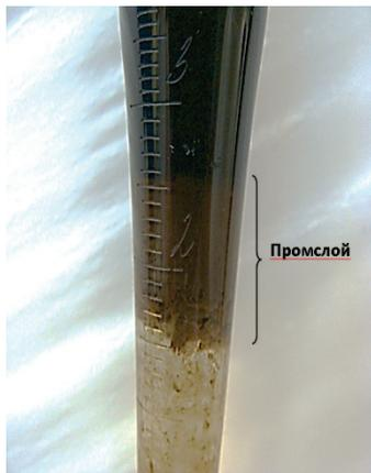
Рис. 3. «Промышленный слой» в пробе добываемой жидкости
