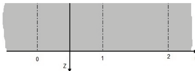
Рис. 2. Фрагмент сеточной области при задании граничных условий на оси симметрии температурного поля, являющегося центром тела
