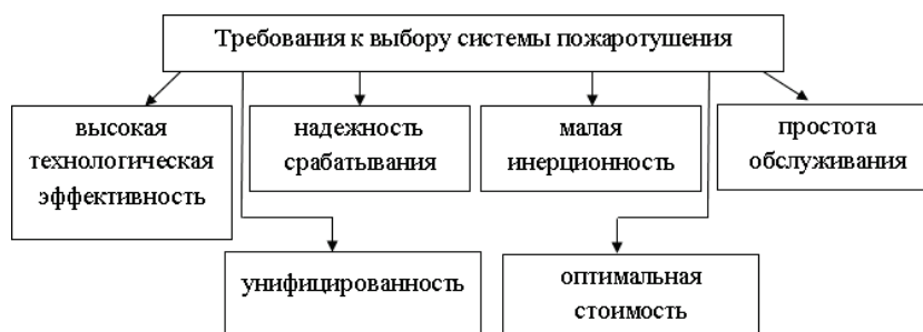
Рис. 2. Приоритетные требования к выбору систем пожаротушения [4]
