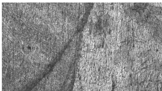
Рис. 3. Наложение слоев в сварном соединении стали 12X18H10T
