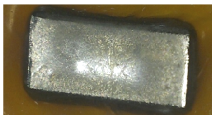
Рис. 1. Образец для испытания на коррозию из стали 20Х13 с покрытием, полученным методом лазерной наплавки
