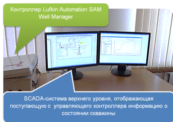
Рис. 1. Система моделирования автоматического контроля режимов работы добывающих скважин
