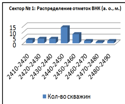
Рис. 1. Гистограмма распределения отметок ВНК по сектору № 1
