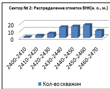
Рис. 2. Гистограмма распределения отметок ВНК по сектору № 2
