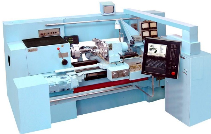
Рис. 1. Экспериментальная установка на базе токарного станка с ЧПУ
