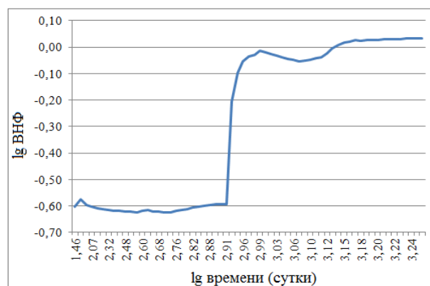
Рис. 5. Распределение ВНФ во времени при прорыве воды по каналам заколонного пространства (скв. 2738, Повховское месторождение, пласт ЮВ1-1)
