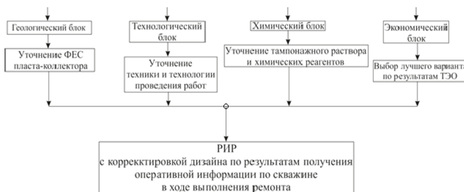
Рис. 8. Блок-схема проведения водоизоляционных работ в скважине с корректировкой дизайна
