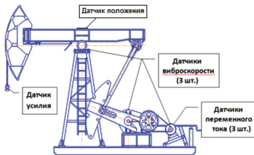
Рис. 3. Схема расположения датчиков контроля состояния наземного оборудования
