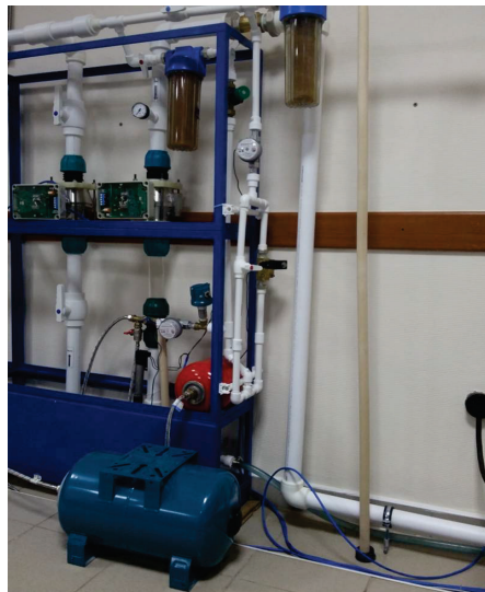
Рис. 1. Имитационный стенд для исследования переходных процессов системы «пласт — скважина — насос»
