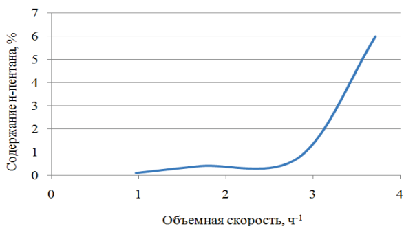
Рис. 3. Зависимость содержания н-пентана в очищенном изопентане от объемной скорости пропускаемого сырья
