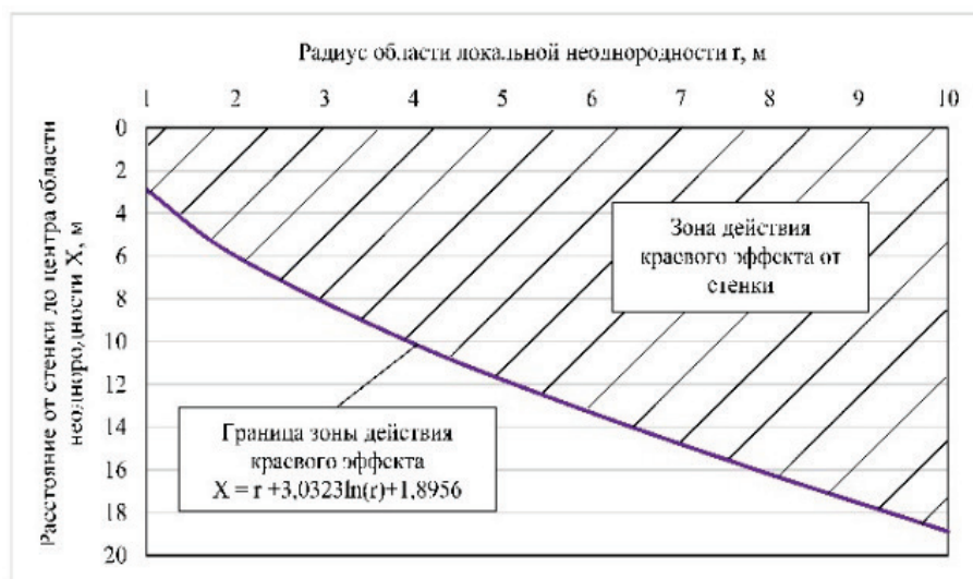
Рис. 5. Граница зоны действия краевого эффекта от стенки резервуара
