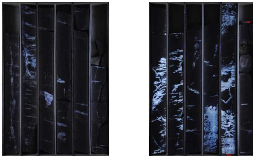
*Рис. 2. Керн в ультрафиолетовом свете, отобранный из скважины 2Р из интервала ДЮК*
