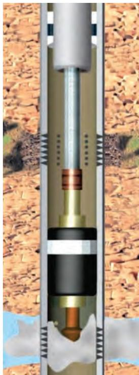
*Рис. 1. Пример применения надувного пакера компании TAM при ремонтно-изоляционных работах*
