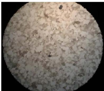
*Рис. 1. Микрофотография пришлифовки торцевой части керна*
