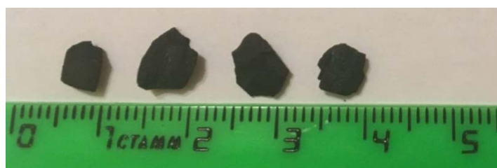
Рис. 5. Внешний вид и средний размер гранул получаемого нановолокнистого углеродного материала
