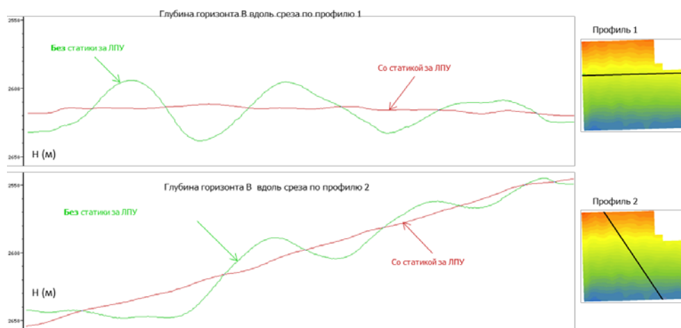
Рис. 9. Разрезы по картам глубин горизонта В, полученные с использованием эффективных скоростей, оцененных по сейсмограммам без ввода статических поправок за ЛПУ (зеленым цветом) и с применением статических поправок за ЛПУ (красным цветом)
