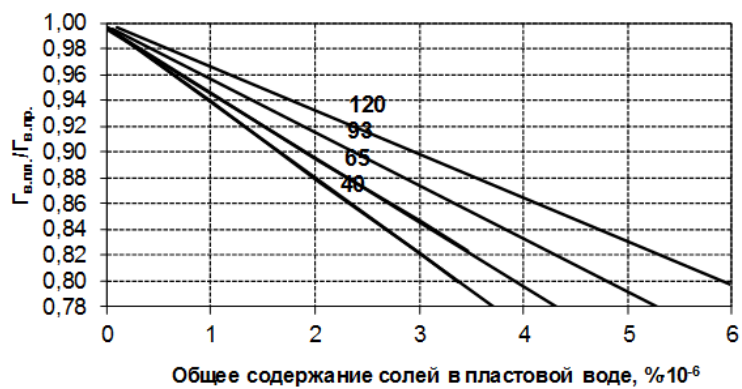
Рисунок. Растворимость природного газа в воде (по С. Р. Додсону и М. Б. Стендингу): а) в пресной воде; б) с поправкой на минерализацию пластовой воды
