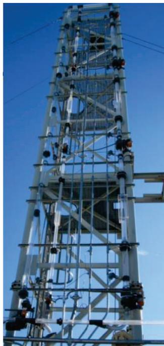
*Рис. 4. Экспериментальный стенд для исследования газожидкостных потоков (Университет Талсы, г. Талса, США)*
