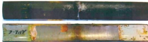
Рис. 10. Внешний вид образцов после выдержки. Среда № 4
