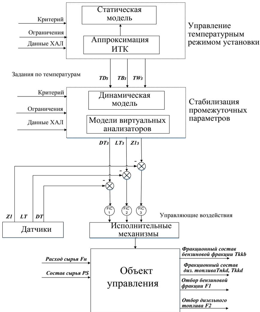
Рис. 3. Функционально-структурная схема решения задачи управления
