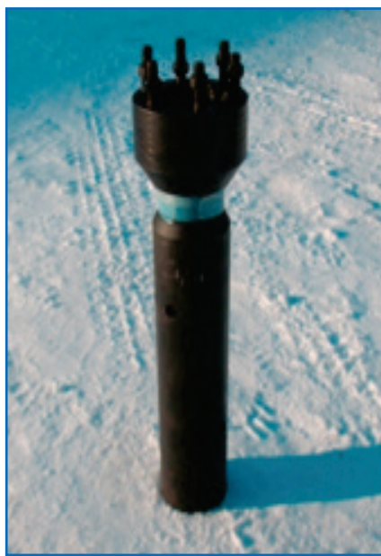
Рис. 2. Акустический режекторный фильтр
