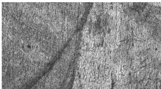
*Рис. 3. Наложение слоев в сварном соединении стали 12X18H10T*
