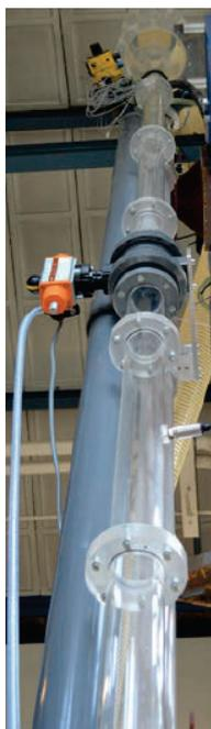
Рис. 3. Лифтовая колонна экспериментальной установки (Делфтский технический университет, г. Делфт, Нидерланды)
