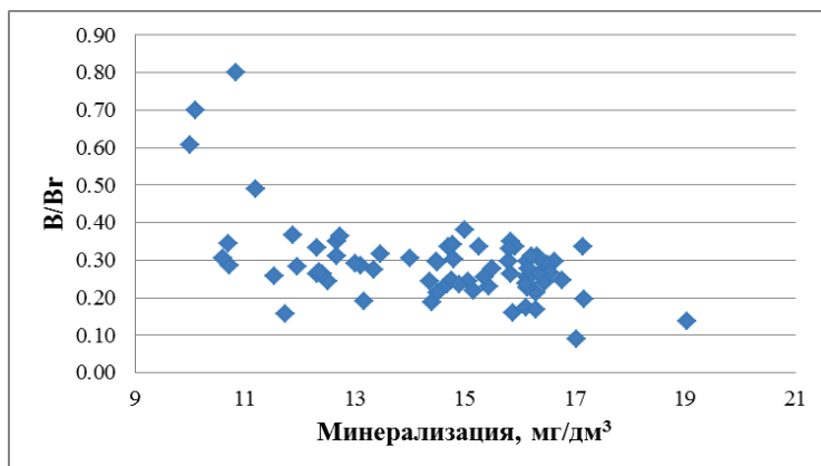
Рис. 6. Зависимость генетического бор-бромного коэффициента метаморфизации от минерализации пластовых вод
