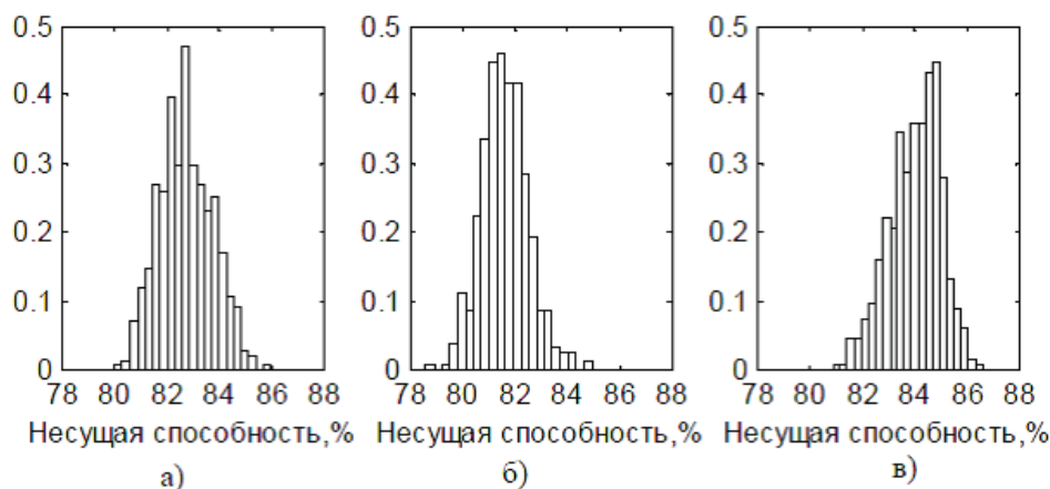
Рис. 2. Гистограмма несущей способности стального каната при различных исходных вероятностях разрушения проволок: а) P_i = 1/N ; б) P_i \sim A_i ; в) P_i \sim 1/A_i
