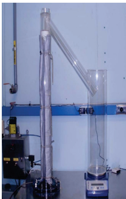
Рис. 3. Фото установки для определения безразмерного коэффициента U_{lrss}/U_{sgss}
