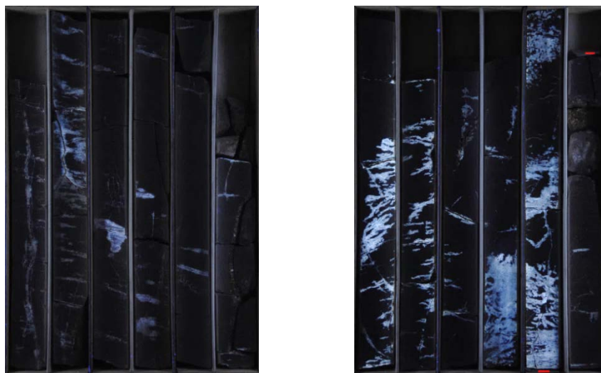
Рис. 2. Керна в ультрафиолетовом свете, отобранный из скважины 2Р из интервала ДЮК
