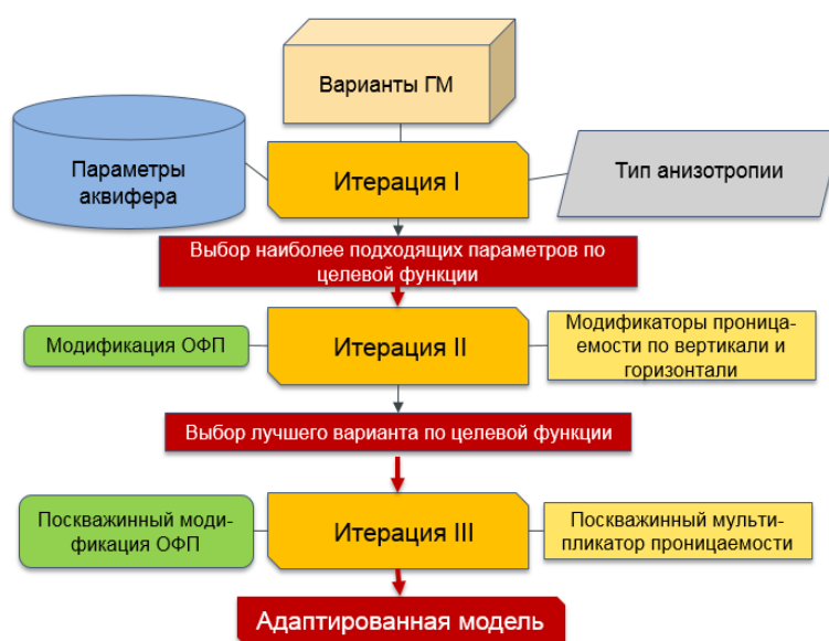
Рис. 11. Алгоритм итерационного моделирования на этапе настройки гидродинамической модели
