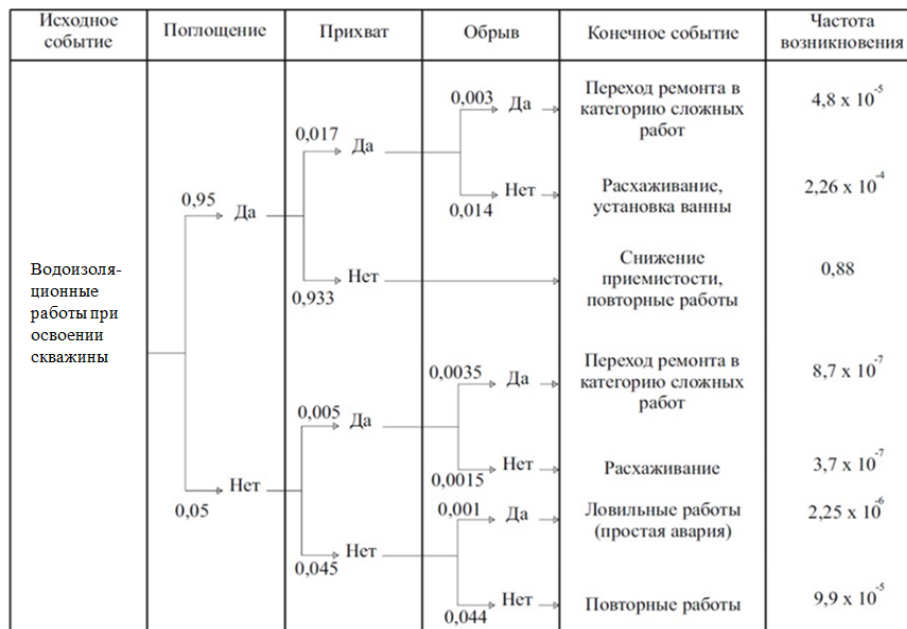
Рисунок. Сведения о частотах возникновения осложнений при проведении водоизоляционных работ логико-графическим методом («дерево событий»)
