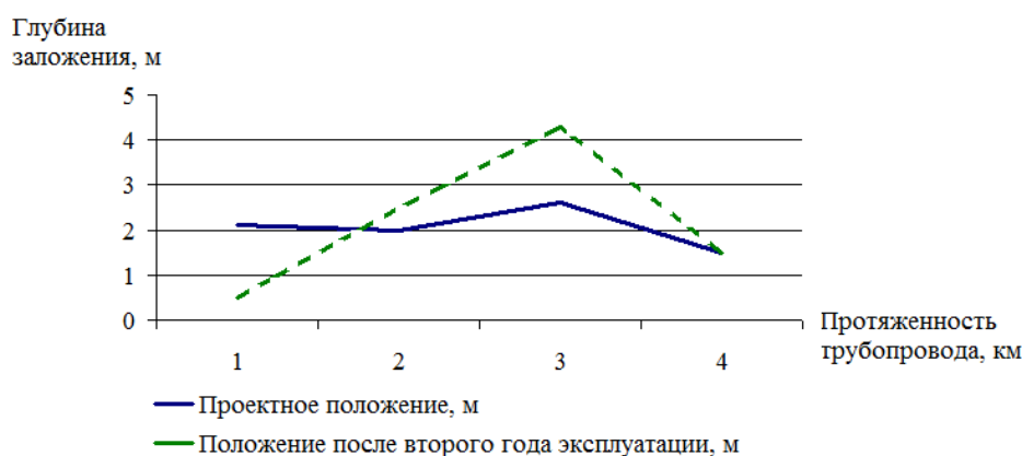
Рис. 3. Изменение расположения газопровода (второй год эксплуатации, зима)
