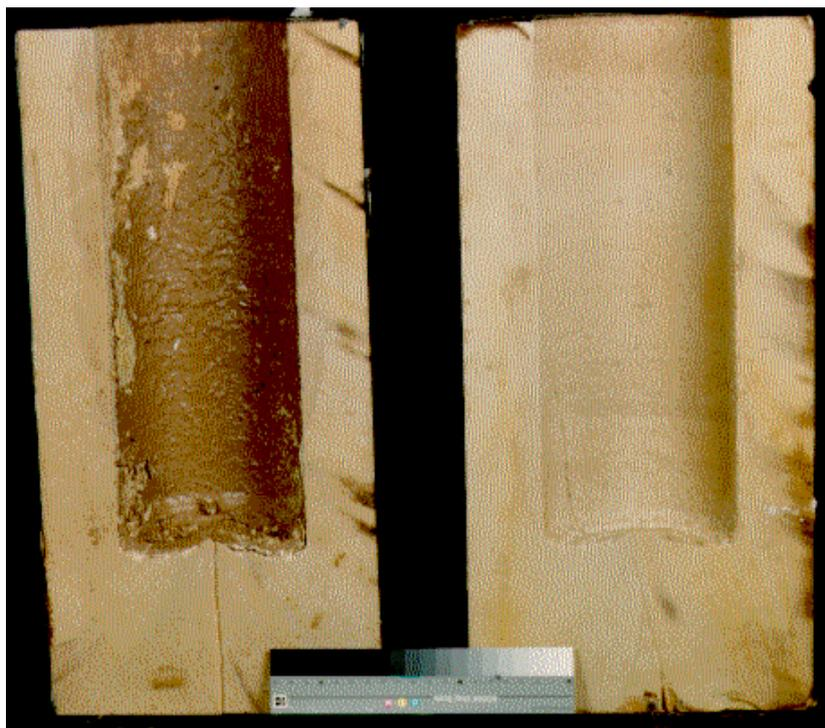
*Рис. 4. Распил образцов породы: слева — пробуренной традиционным способом без волнового воздействия, справа — распил образца той же породы, пробуренной при волновом воздействии*
