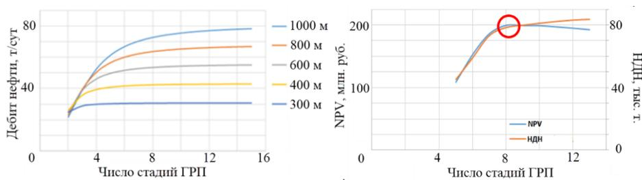
Рис. 8. Результаты расчетов оптимальной конструкции скважин
