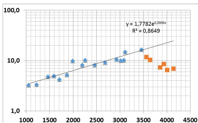
**Рис. 2. Пример изменения геофизических параметров с глубиной по скв. 182 Ямбургского месторождения (по оси Y — относительное сопротивление, по оси X — глубина скважины)**
