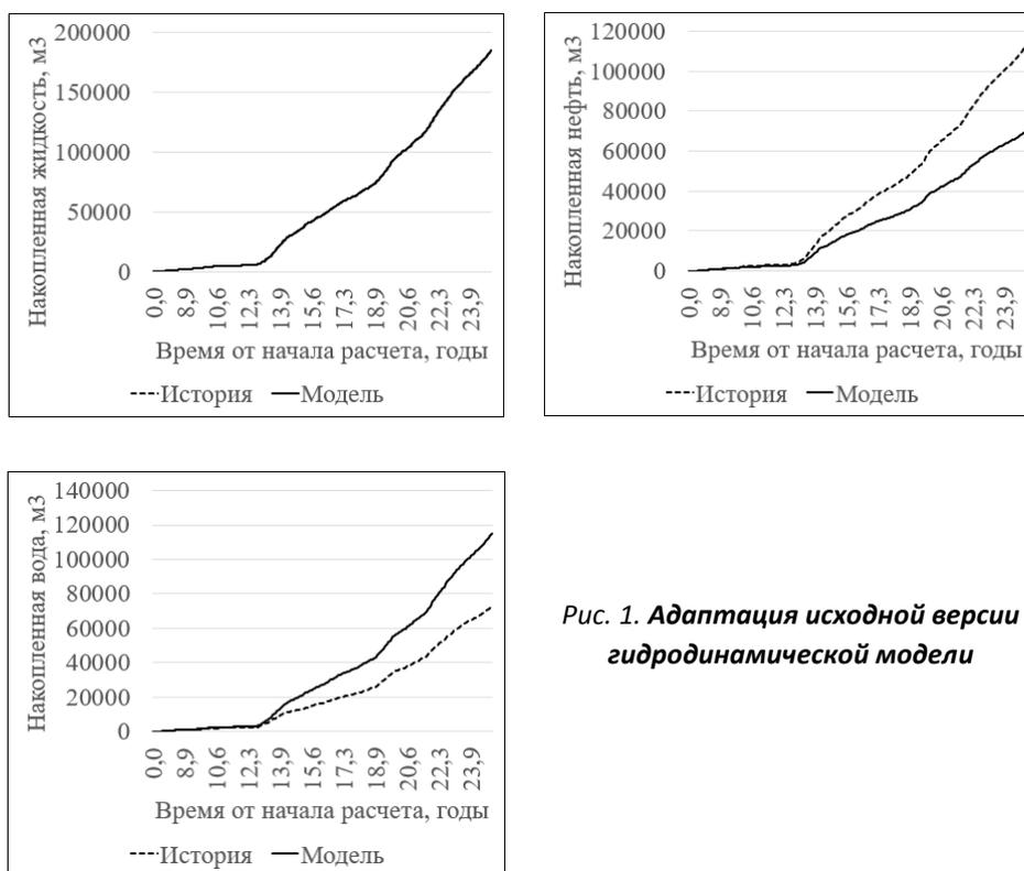
Рис. 1. Адаптация исходной версии гидродинамической модели
