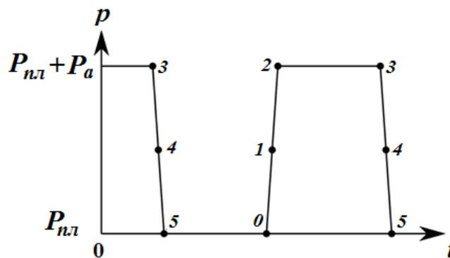
Рис. 2. Временная организация импульсов давления в околоскважинной зоне
