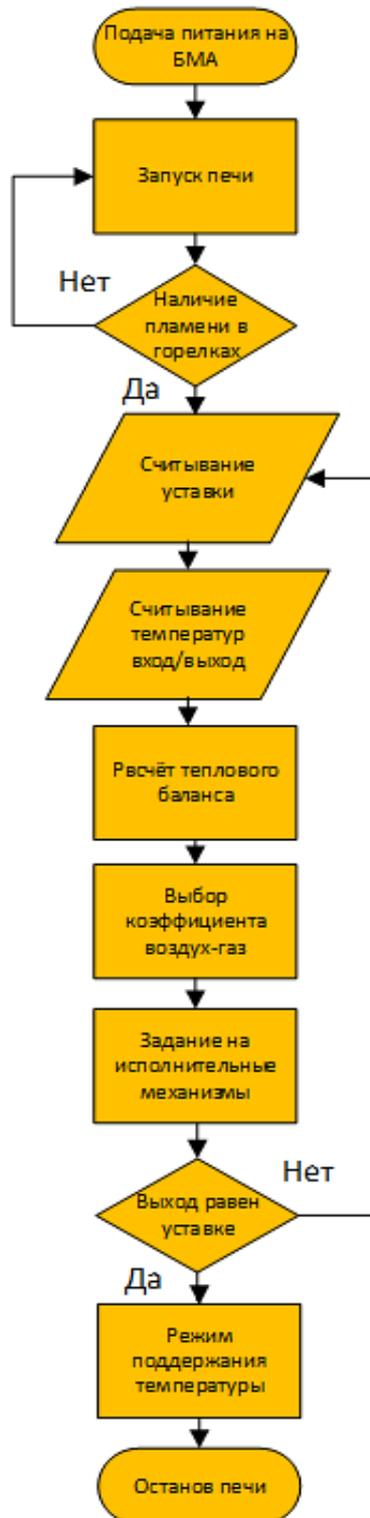
Рис. 3. Алгоритм управления работой печи
