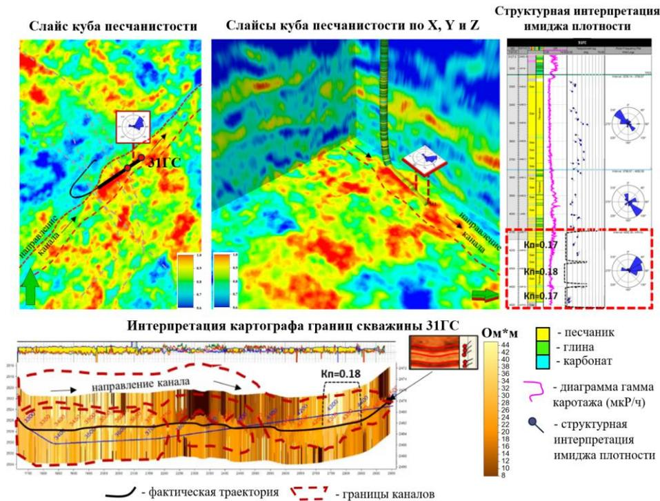
**Рис. 6. Канал, вскрытый третьей частью горизонтальной скважины в процессе бурения**
