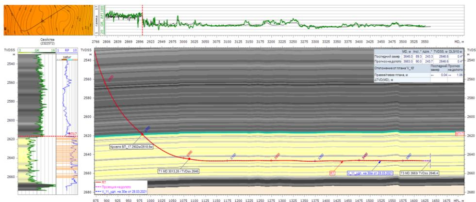
Рис. 10. Проводка скважины № 2325 в подошвенную часть пласта
