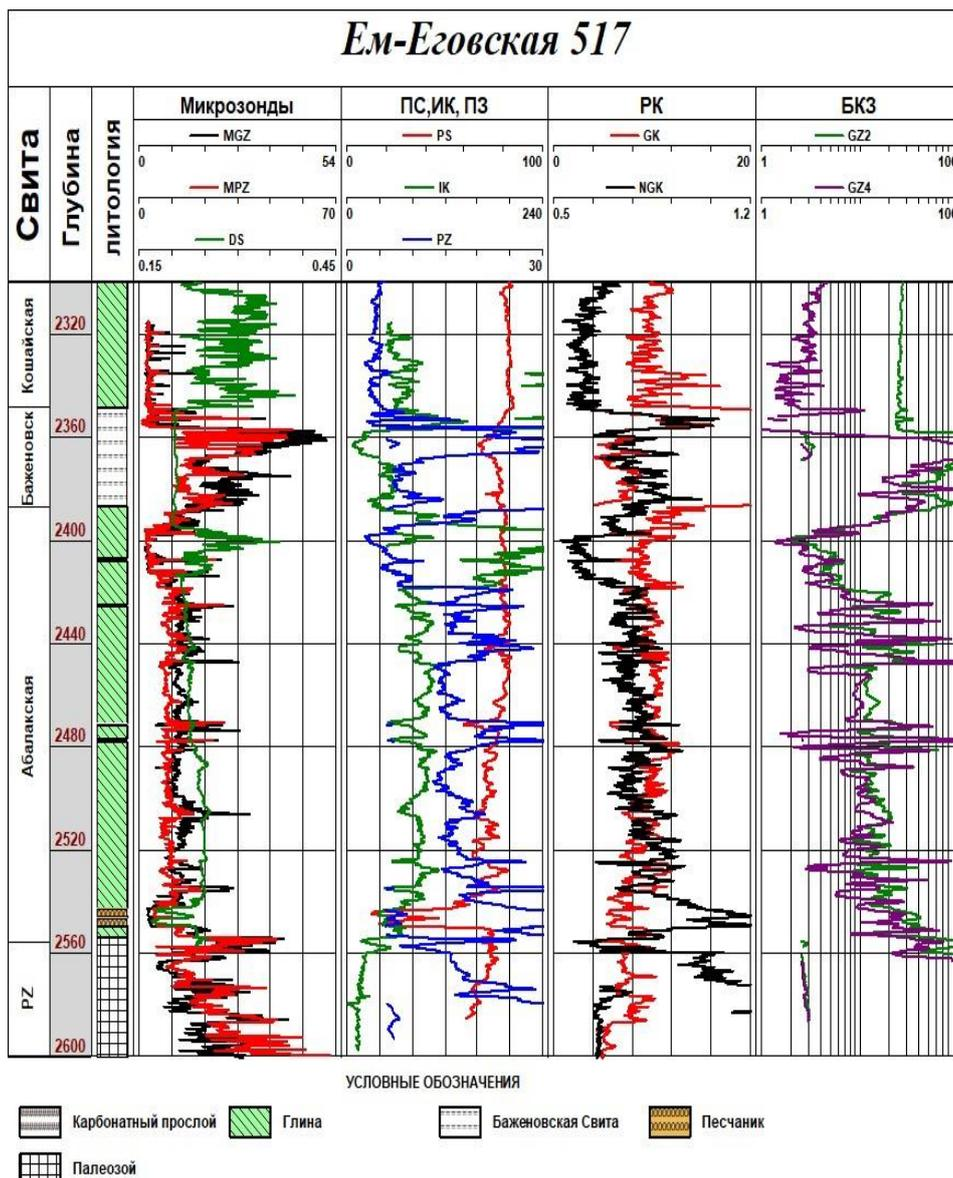
**Рис. 6. Геофизический разрез в зоне аномальных давлений в скв. 517
