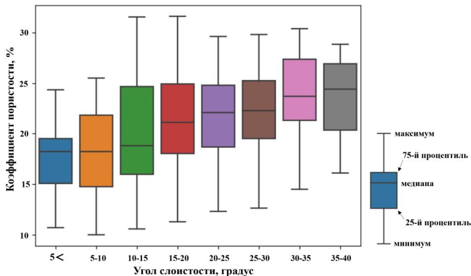
Рис. 7. Зависимость коэффициента пористости песчаных пропластков от угла слоистости
