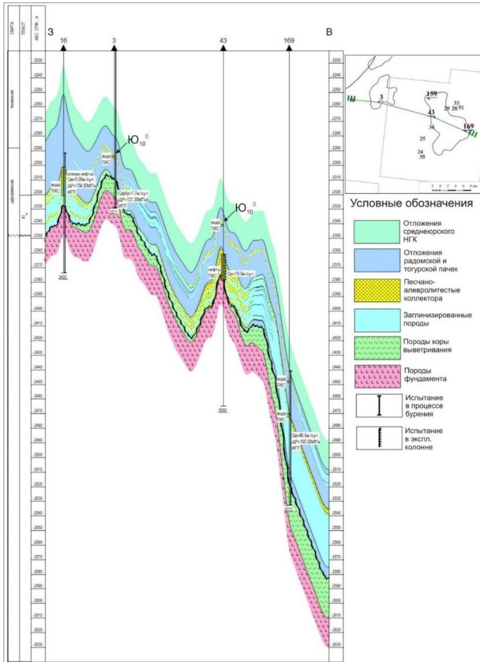
Рис. 6. Геологический разрез нижеюрских отложений по линии скважин: Хопыньгюганская — 16; Няргюганская — 3; Сергинская — 43; Каремпостская — 169
