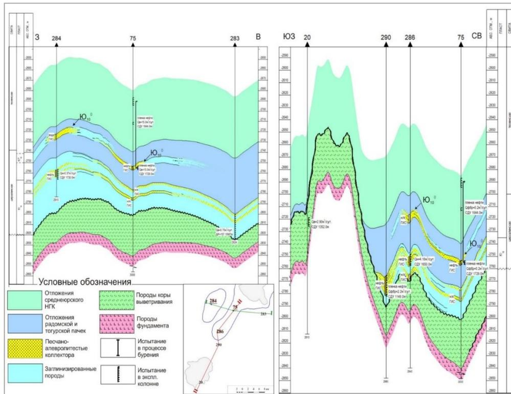
Рис. 3. Геологические разрезы через скважину 75 Большую
