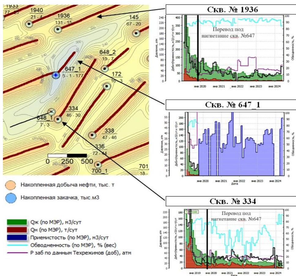
Рис. 2. Анализ системы поддержания пластового давления пласта X-17
