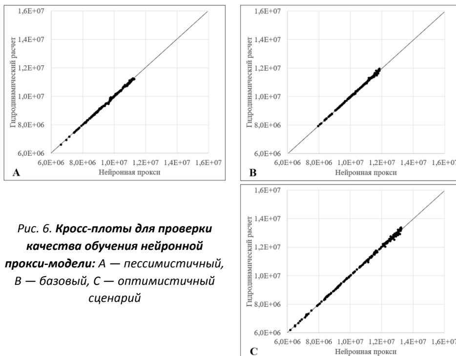
**Рис. 6. Кросс-плоты для проверки качества обучения нейронной прокси-модели: А — пессимистичный, В — базовый, С — оптимистичный сценарий**
