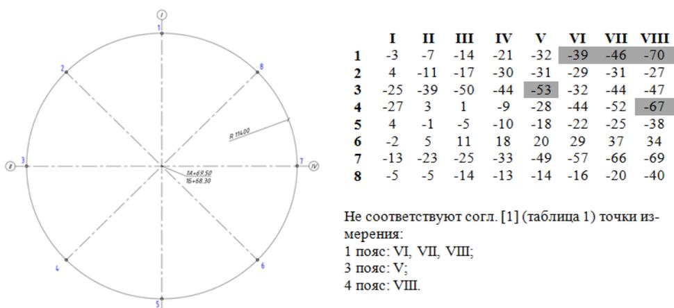
Рис. 1. Исполнительная схема отклонения от вертикали образующих стенки на высоте каждого пояса после гидравлических испытаний
