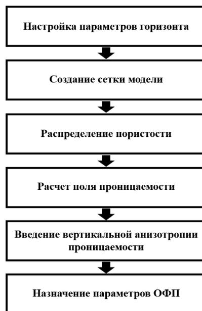
Рис. 2. Концептуальная блок-схема Workflow
