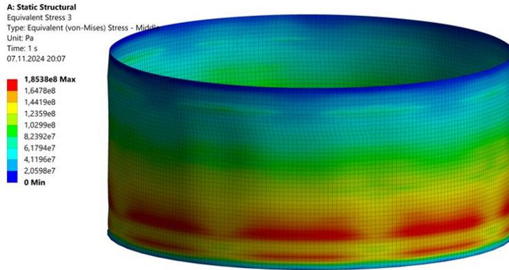
Рис. 3. Максимальные эквивалентные напряжения при  $H = 11,04$  м;
