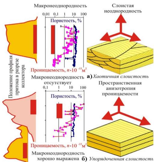
Рис. 4. Характеристика макронеоднородности и слоистой неоднородности: а — хаотичный тип; б — упорядоченный тип
