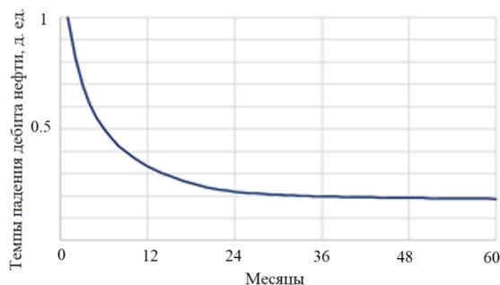
Рис. 1. Темпы падения дебита нефти пласта X-17
