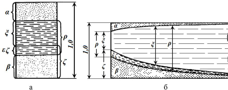
Рис. 1. Схема заполнения порового пространства в процессе фильтрации смеси: фронтальный вид (а) и вид сбоку (б)
