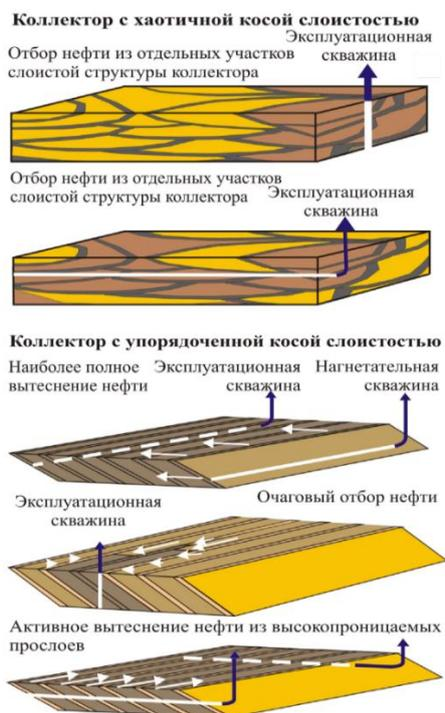
Рис. 3. Особенности вытеснения нефти из песчаников с хаотично-слоистой и упорядоченно-слоистой структурой резервуара
