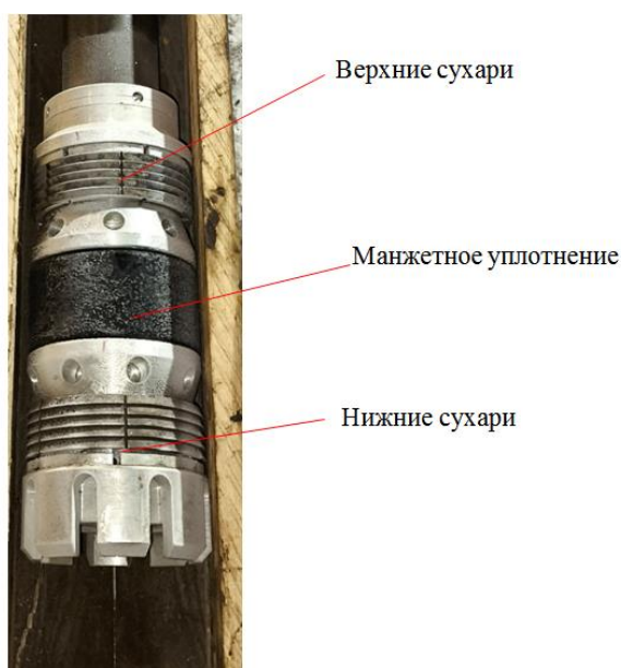
Рис. 4. Проблемные элементы при разбухании пакер-пробки
